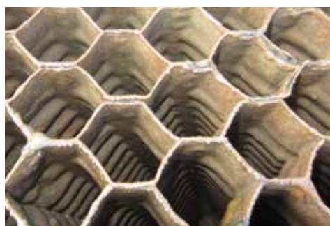
ODORdek-Packung mit gleichmäßigem Biofilm
